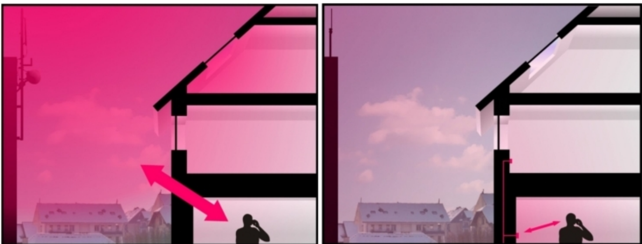
Starke Strahlung: Mobilfunk muss Häuserwände durchdringen
