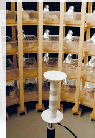
Aus Holz gebautes Expositionssystem für Versuchstiere der Ramazzini-Studie 21 , vgl. Bildlegende S. 19. © 2013
